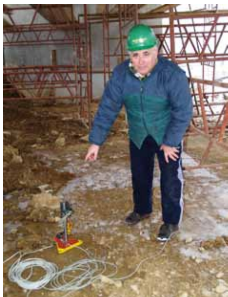
Prof. Ing. Josef Vičan, CSC., ukazuje sondu, pomocou ktorej sa zachytáva prehyb mosta.
