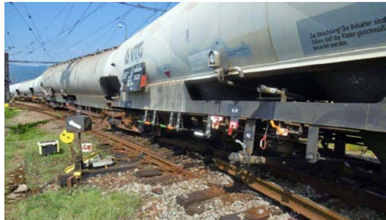
Vykoľajené vozne nákladného vlaku vo Vrútkach.
