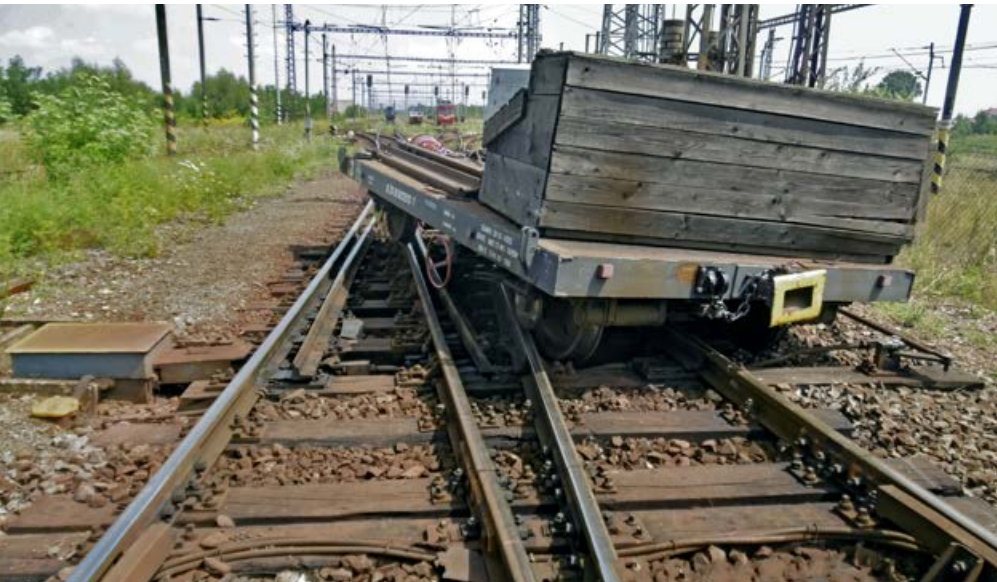
Prívesný vozík vykoľajený pri posune.
