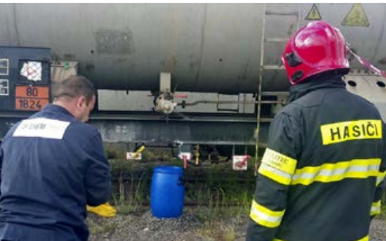
NŽST Zvolen - východ. Na tejto fotografii je zachytený reálny únik hydroxidu sodného cez vypúšťací ventil.
