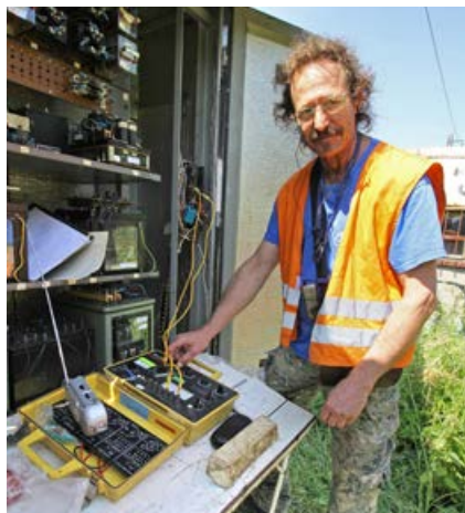
Ján Rybníkač, merací technik dodávateľa, meria parametre traťového kábla.
