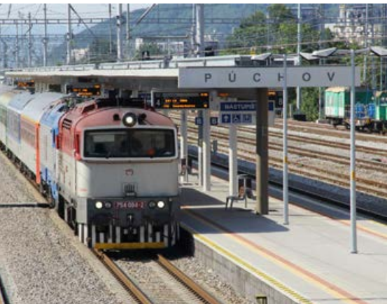
Púchov zažil 1. augusta 2015 historickú chvíľu. V rámci uniifikácie trakčných prúdových sústav v sieti ŽSR došlo v modernizovanej železničnej stanici k premiérovému prepnutiu jednosmernej sústavy 3 kV na striedavú 25 kV. Táto zmena sa najviac dotkla dopravcov jazdiacich na ramene Žilina – Púchov – Horní Lideč.
