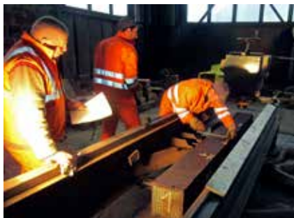
Typickou činnosťou mostárov v zimných mesiacoch je opravovanie drevených mostníc pre plánovanú súvislú výmenu.
