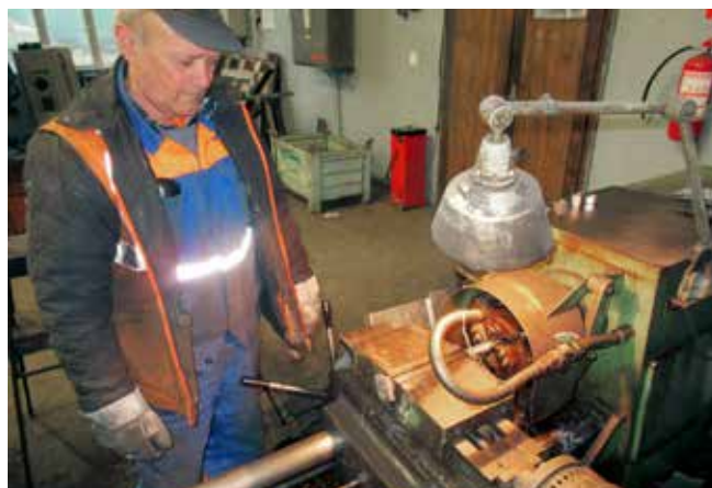
Ján Kipikaša z výkonného pracoviska SMÚ MO Margecany odfotený pri výrobe mostnicových skrutiek.
