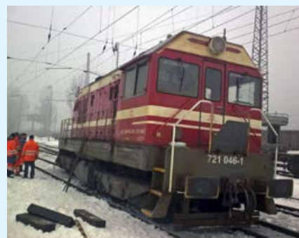
Posunovacia záloha v železničnej stanici Žilina sa v dôsledku lomu ocitla mimo koľaje.
