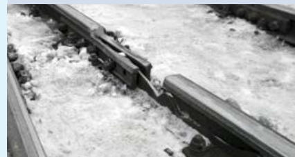
Posunovacia záloha v železničnej stanici Žilina sa v dôsledku lomu ocitla mimo koľaje.
