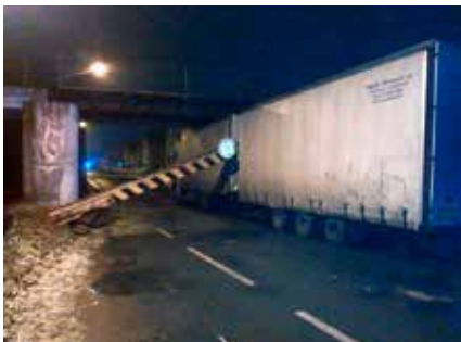
Pri cúvaní nákladu spod mosta spadla protinárazová zábrana presne medzi vozidlo a príves.
