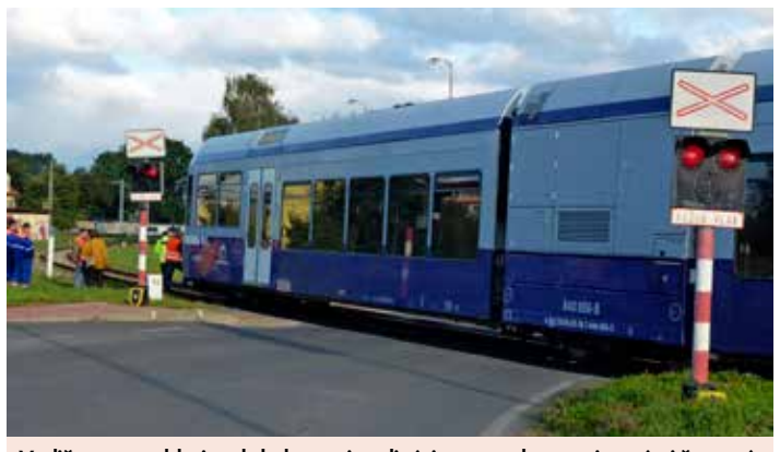
Vodič auta sa obhajoval chybnou signalizáciou a trvalo rozsvietenými červenými svetlami na výstražníku. Elektronický archív zabezpečovacieho zariadenia dokázal, že v čase nehody všetko fungovalo správne.
