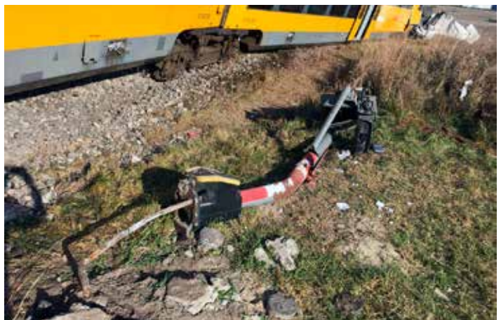
Pri zrážke sa vlaková súprava okrem posledného dielu kompletne vykoľajila. Vyvrátila aj výstražník zabezpečovacieho zariadenia.
