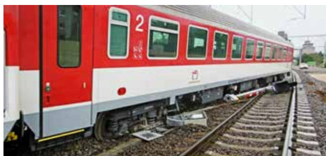
Pri vykoľajení osobného vlaku v Zlatovciach vznikli vysoké materiálne škody na zmodernizovanom železničnom zvršku.
