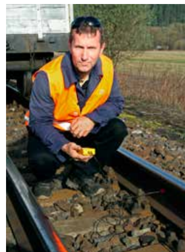
Jaroslav Šebest, koordinátor SMSÚ ŽTS TO Liptovský Mikuláš, meria teplotu koľajnice. Bezstyková koľaj sa môže zriaďovať iba pri dovolených upínacích teplotách koľajnic od 17 do 25 °C.
