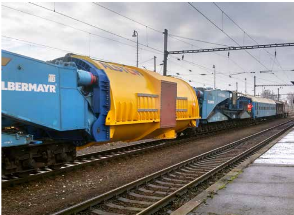
Preprava obrieho transformátora po tratiach ŽSR si vyžadovala viacero dopravno-prepravných obmedzení.
