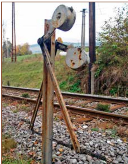
Pákový doťahovač. Súčasť mechanicke ovládaných predzvestí.
