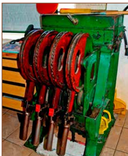
Zariadenie na obsluhu mechanických vchodových návěstidiel a ich predzvestí.
