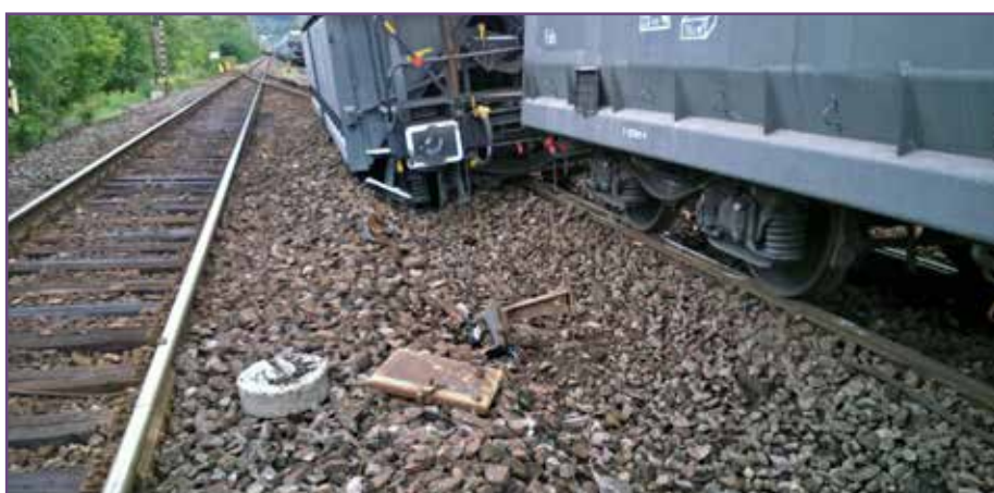
Pri nehode došlo k vykoľajeniu vozňa a roztrhnutiu vlaku.
