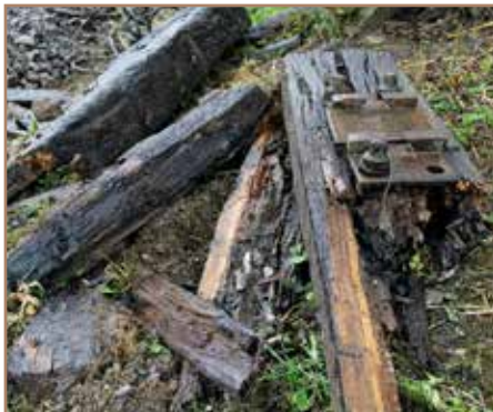
Akákoľvek jazda železničného vozidla po manipulačnej kolaji s takýmito podvalmi bola mimoriadne riskantná.
