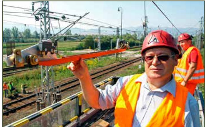
Dušan Michalko predvádza spoľahlivosť mechanického senzora v úseku, kde už má byť zberač na rušni stiahnutý. Ak nie je, zberač nadvihne oranžovú lištu a aktivuje zariadenie.
