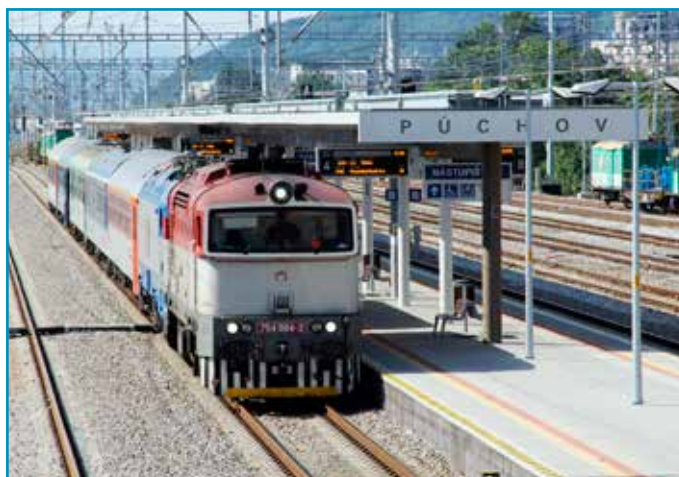
Prevádzka v stanici bola počas výluky výrazne obmedzená. Pod trolejom bez napätia jazdili iba osobné vlaky diaľkovej dopravy, ťahané rušňami nezávislej trakcie, najčastejšie radou 754.
