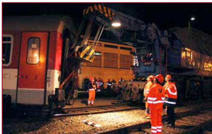
Nakoľajenie vozňa bolo v réžii košických mostárov. Aj napriek tme odvedli profesionálnu prácu.
