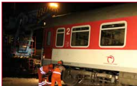
Mostári dostali vozeň na koľaje pomocou nehodového žeriavu. Plynulosť prác komplikovali len podvozky vozňa, ktoré boli zaseknuté o fekálne nádrže a poistkové skrine.
