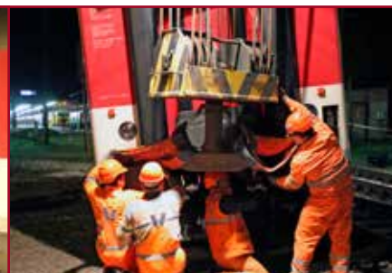
Mostári dostali vozeň na koľaje pomocou nehodového žeriavu. Plynulosť prác komplikovali len podvozky vozňa, ktoré boli zaseknuté o fekálne nádrže a poistkové skrine.
