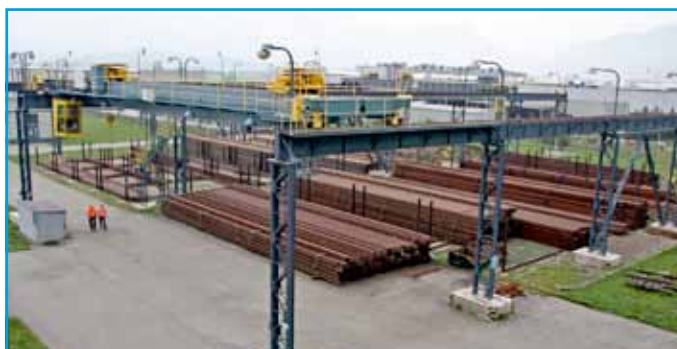
Na skládkovej ploche SMSÚ ŽTS ZRS Vrútky sa nachádzajú nové aj regenerované koľajnice rôznych profilov, pripravené na zváranie.
