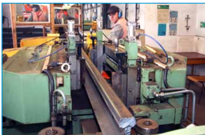
Marián Roľko hydraulickou rovňačkou vyrovnáva použitú koľajnicu v horizontálnej aj vertikálnej rovine.
