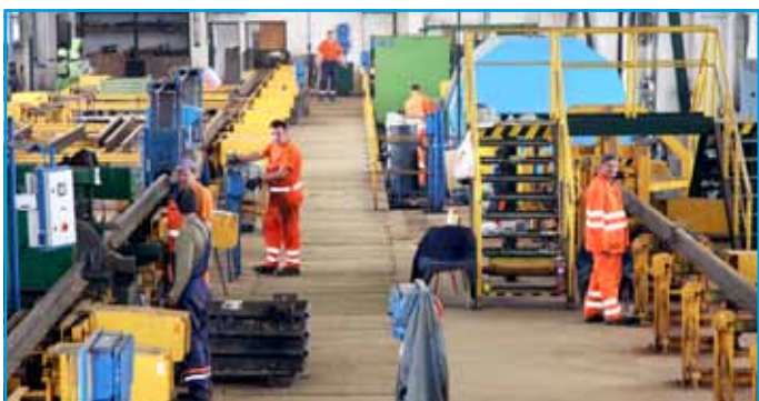
Pohľad do haly. Regeneračná linka naľavo spracúva použité koľajnice, dlhé koľajnicové pásy vznikajú napravo na zvaracej linke. Koľajnice sa posúvajú po valčekovej dráhe.
