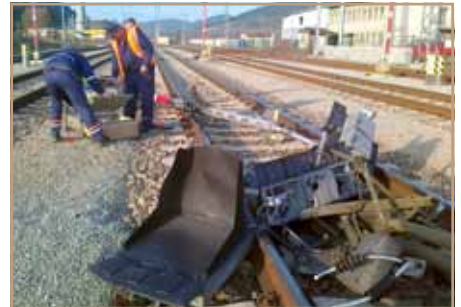
V Kysuckom Novom Meste spadol poškodený zberač rušňa aj s vytrhnutým návestidlom do susednej staničnej koľaje. Našťastie po nej nešiel vlak.
