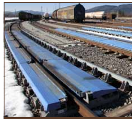
Na spádovisku je až 126 brzd. Najmä v prvých mesiacoch prevádzky sa občas stávalo, že spúšťané odvesy dostatočne neubrzdili a vozne prešli až na relačnú koľaj.
