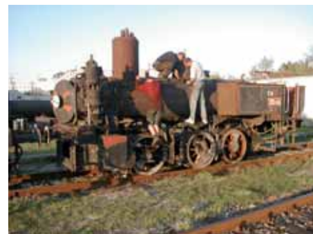
Prvé práce na odstrojení rušňa 310.097 pred druhou veľkou opravou.
