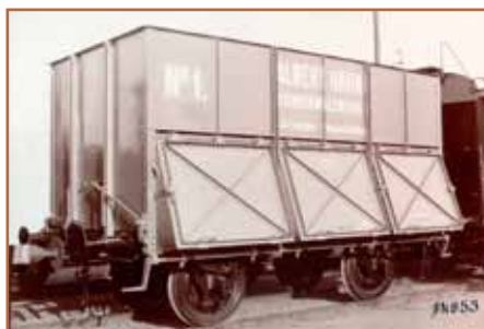
Jeden z prvých typov celokovového výspného vozňa pochádzajúceho z roku 1914.
