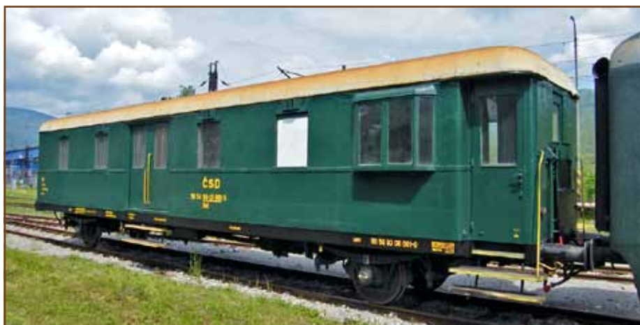
Povojnový celozváraný služobný vozeň nepoprie svoju príbuznosť k rozšíreným osobným vozňom typu „Rybák“.
