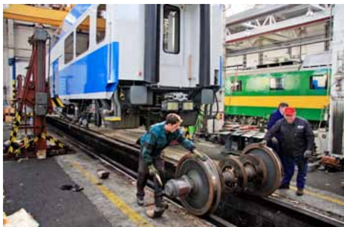
V dielenskej hale ZSSK CARGO v Haniske pri Košiciach dostali súpravy širokorozchodné podvozky, aby mohli ďalej pokračovať do ukrajinského Charkova.
