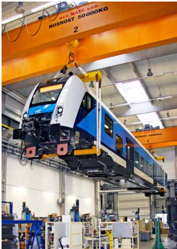
Montážne haly plzenskej Škodovky produkujú okrem motorových vozov poschodových jednotiek, elektrických rušňov radu 380 a 381, rôznych typov elektríciek aj elektrické jednotky radu 650. Jedna z rozpracovaných 19 jednotiek RegioPanter pre České dráhy.
