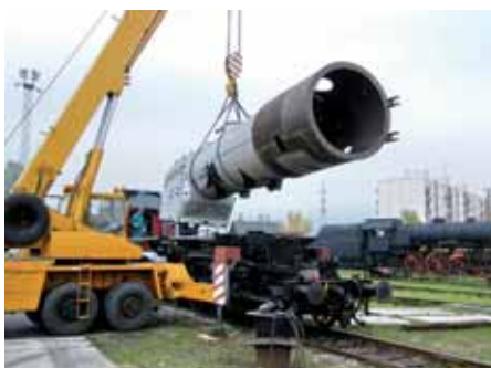
Zaväzovanie kotla rušňa 555.3008 do rámu pomocou automobilového žeriavu s nosnosťou 28 ton.
