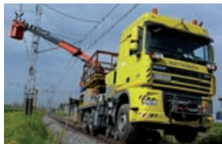
Jedným z montážnych prostriedkov bolo aj špeciálne dvojcestné dráhové vozidlo DAF XF 105 DUO vybavené koľajovými adaptérmi, umožňujúcimi pohyb po koľajach normálneho aj širokého rozchodu. Montérom je k dispozícii pohyblivá montážna plošina aj hydraulická ruka s montážnym košom a dosahom 19 metrov.
