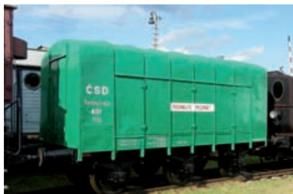
Zachovaný tárovací vozeň č. 401 ČSD po oprave
