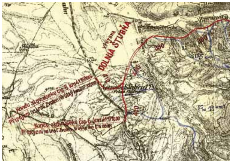
Podrobný návrh vedenia trate B. Bystrica – Diviaky s odbočkou do stanice Horná Štubňa, schválený 23. januára 1937 a zakreslený do topografickej mapy v mierke 1:25000.
