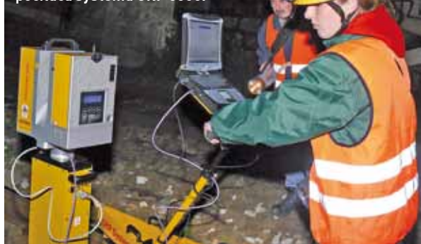
Ing. Janka Kubernátová kontroluje prenos dát zo skenera do integrovaného počítača systému GRP 5000.
