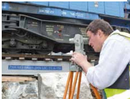
Ing. František Bahleda zo Žilinskej univerzity pozorne sleduje klesanie betónových opôr, podľa predpokladov je všetko v tolerancii
