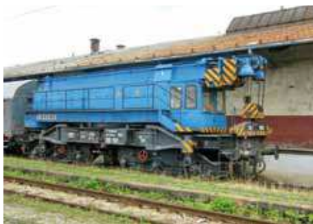
Žeriav typu EDK 300/5 s teleskopickým výložníkom, s ktorým sa v prevádzke môžeme aj dnes bežne stretnúť.
