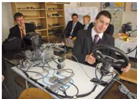
Pneumatické ovládanie rýchlosti motora motokáry na princípe formuly predviedol Jozef Pšák z SOŠ technickej v Michalovciach.
