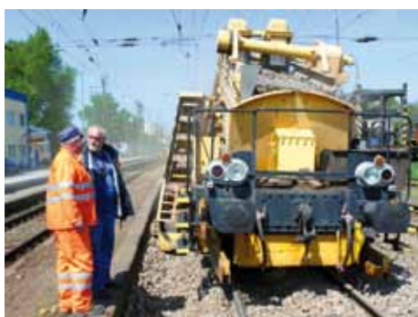
Jozef Košťál (vpravo), stavbyvedúci SMÚ ŽTS TO Bratislava, konzultuje priebeh výlukových prác s Rastislavom Stúpalom, strojníkom obsluhujúcim strojnú čističku SČH 150 z SMÚ ŽTS MDS Bratislava.
