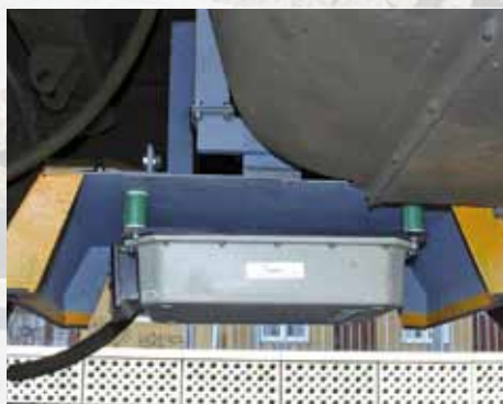
Anténa, umiestnená na spodnej časti hnacieho vozidla, neustále vysiela energetický signál. Ten aktivuje eurobalízu, ktorá do antény vyšle príkaz.
