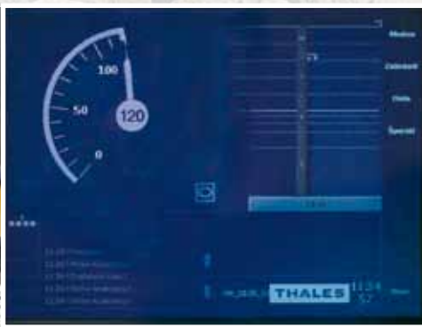
Pred vodičom dráhového vozidla sa nachádza zobrazovací a ovládací prístroj s dotykovým displejom. Zreteľný je rýchlomer s údajom o rýchlosti, pod ktorým sa objavujú textové názvy. Napravo je viditeľná plánovacia časť.
