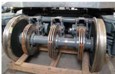
Brzdový systém zaisťuje prevádzkové i záchranné brzdenie. Elektrodynamickej brzda je využívaná pri brzdení prednostne.
