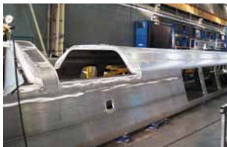
Konštrukcia skrine vlaku je zostavená a zväraná z veľkoplošných pretláčaných profilov z hliníkových zliatin.
