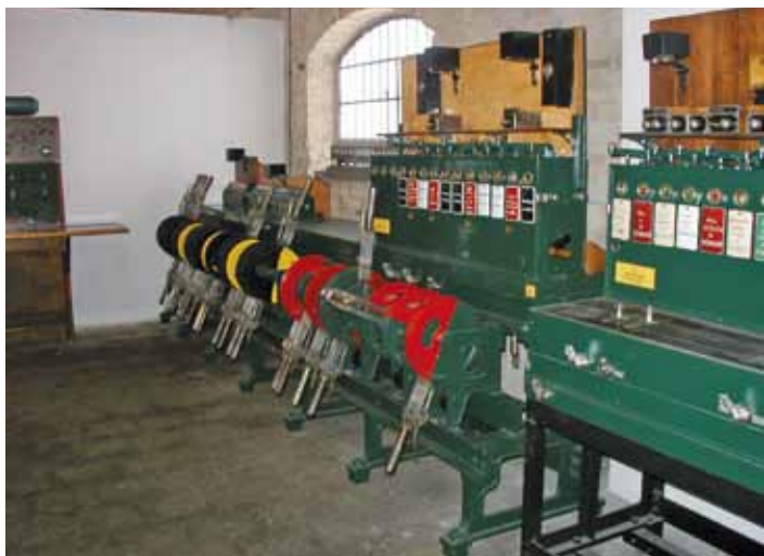
Stavadlový prístroj s pravítkovou logikou v múzeu dopravy. Pochádza zo stanice Nové Mesto nad Váhom.
