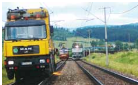
Brúsiace vozidlo v plnom nasadení, až z neho iskry lietajú... Nič však nebráni tomu, aby na vedľajšej koľaji nemohol ísť vlak.
