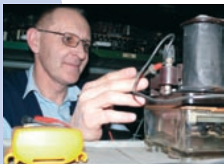
Pri pravidelnej údržbe relé vo voľnej väzbe, ktoré sú naukladané na policiach jednotlivých stojanov, musí mať návestný majster František Síkora znalosti nielen z elektrických obvodov, ale aj z ruštiny.
