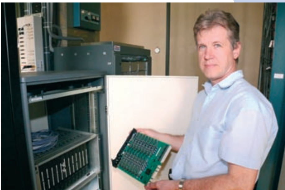
- Táto karta z novej ústredne, určená pre 32 digitálnych účastníkov, nahradí 3 vysoké stojany s elektromechanickými prvkami voličovej ústredne, - vysvetľuje Ing. Rudolf Leško, vedúci skupiny hlasovej a dátovej techniky košickej pobočky ŽT.
