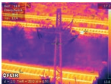
K termovíznejmu meraniu bola zabezpečená spolupráca medzi meracími skupinami TÚI Prešov a RSE Košice, čím sa dosiahlo, aby sa zariadenia TV a samotné TV dostatočne zatažili a niektoré nedostatky potom „svietili“.
