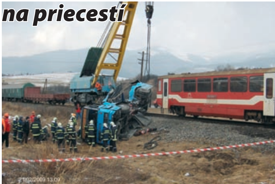
Zdvihnutie motorového rušňa a odstránenie autobusu z trate sa podarilo žeriavom z nehodového vlaku zo Zvolena.
