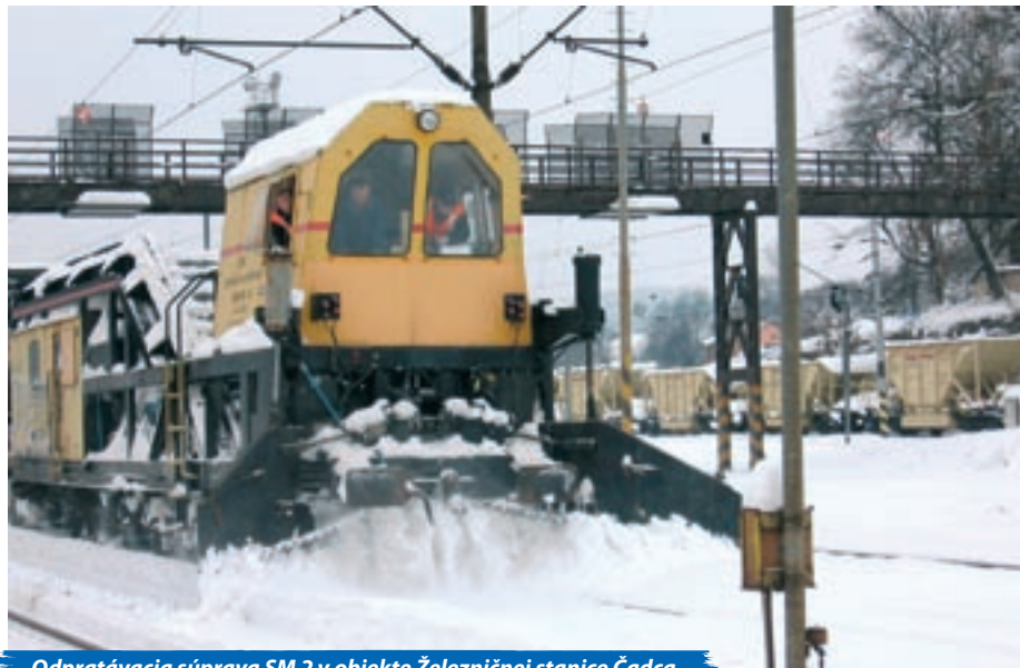
Odprátavacia súprava SM 2 v objekte Železničnej stanice Čadca.
