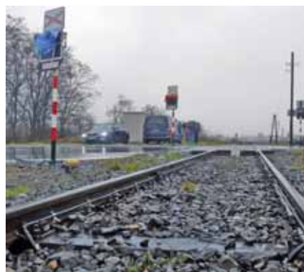
Indukčná slučka FSSB 60/80 je prichytená cez 10 podvalov, nesmú však byť ocelové. Takéto snímače sa uplatňujú najmä v koľajiskách, kde miestne pomery neumožňujú nasadenie klasických koľajových obvodov.
