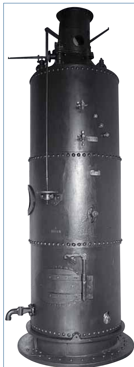
Zreštaurovaný vodárenský parný kotol v expozícii vodárenstva v Železničnom múzeu Bratislava východ.
