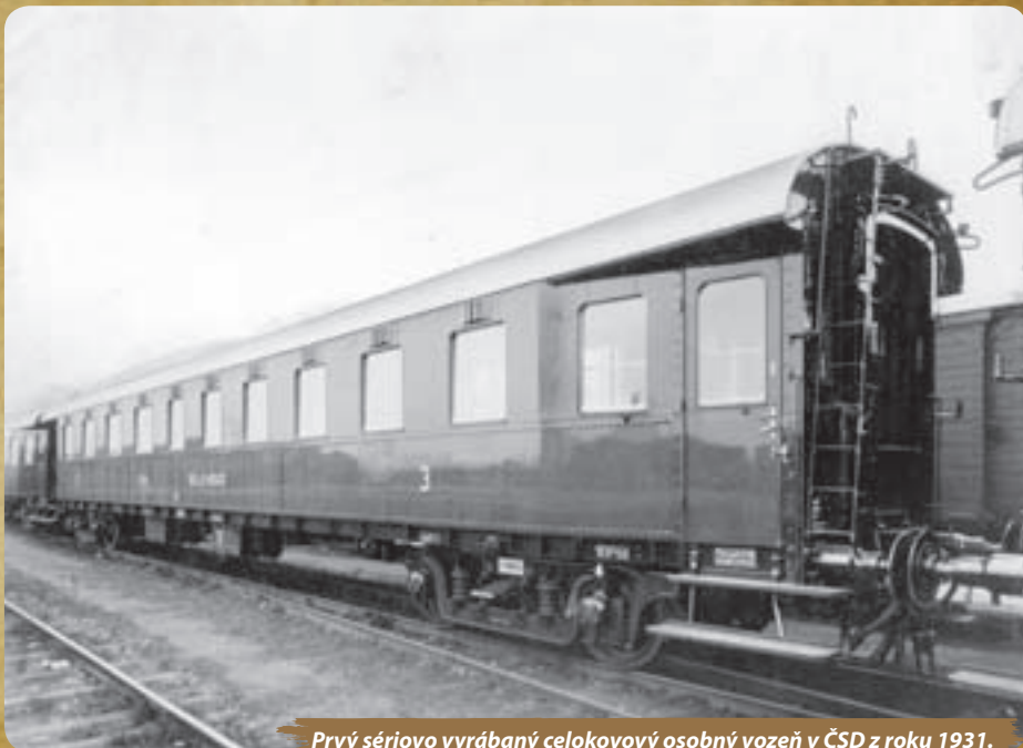
Prvý sériovo vyrábaný celokovový osobný vozeň v ČSD z roku 1931.
