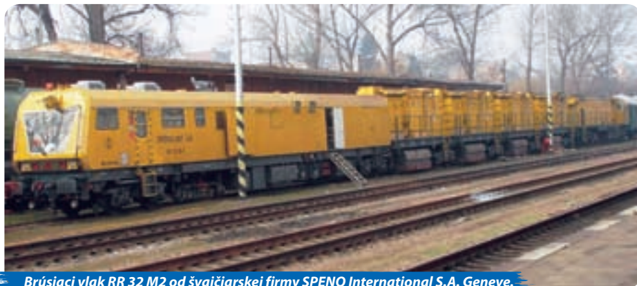
Brúsiaci vlak RR 32 M2 od švajčiarskej firmy SPENO International S.A. Geneve.
