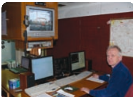
Petr Sedláček kontroluje systém pre merania a záznam údajov. Úlohou počítačov je zber a ukladanie údajov, ich vizualizácia a záznam pre ďalšie spracovanie. Spolupráca zberača a trolejového drôtu sa zaznamenáva aj externou kamerou, z nej sa obraz zobrazuje na TV monitore a súčasne zapisuje na médium (VHS, DVD). Do videosignálu sa ukladajú aj okamžité merané hodnoty.
