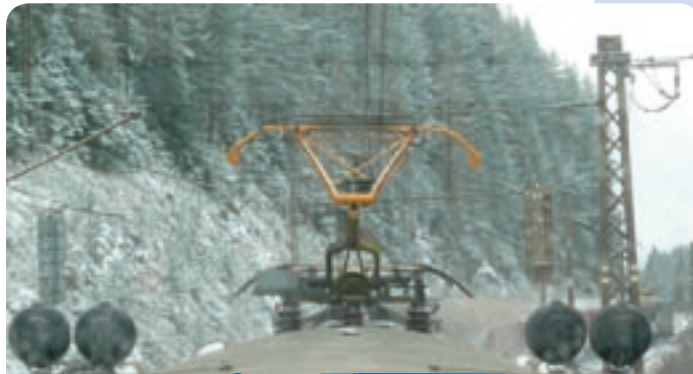
Posádka meracieho vozňa mala i takýto výhľad na celú súpravu IC vlaku. Meranie dynamických parametrov má význam iba pri vyšších rýchlostiach. Odhalujú sa totiž tvrdé miesta, ktoré majú za následok lokálne opotrebované troleje, či poškodený zberač. Priamo na klzných lištách zberača sú namontované tenzometrické snímače síl. V spodnom kĺbe zberača je umiestnený rotačný snímač, ktorý meria výšku trolejového drôtu.
