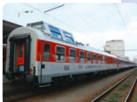
Merací vozň pevných trakčných zariadení SŽDC je pripojený na koniec rozbiehajúcej sa súpravy IC vlaku, aby zberač rušňa neovplyvňoval merací zberač vozňa. Práve sa začína meranie dynamických parametrov, akými sú prítlačné sily medzi zberačom a trolejovým drôtom, či zrýchlenie pozdĺžne aj kolmé na smer jazdy.
