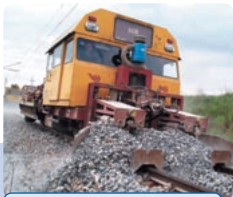
Traťovákovo dôverne známy - uhrabávač štrku PUŠL 71, ktorý sme zastihli na traťovom úseku Beša – Podhájska.
