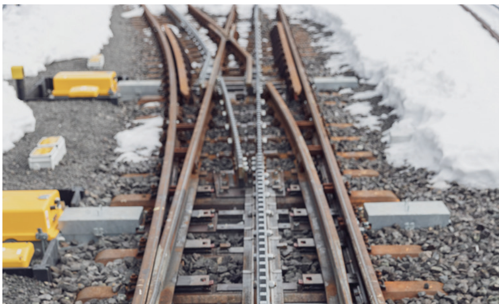
Ozubnicová železnica, kde prenos ražnej sily zabezpečuje ozubené koleso zaberajúce sa do ozubeného hrebeňa v osi koľaje.
