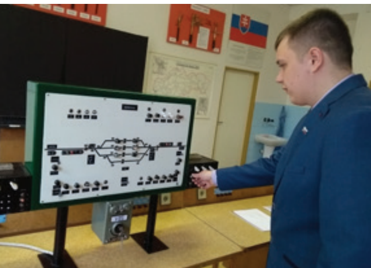
Študent Michal Sokol obsluhuje SZZ TEST 10, ktorý vyrobil pod vedením návestného majstra Marcela Jakuba.
