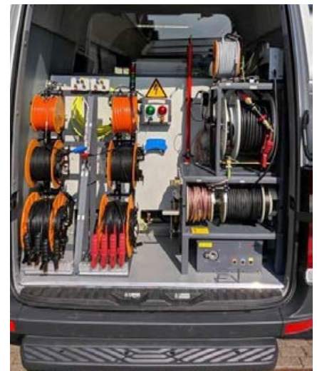
Dodané meracie prístroje: diagnostické cestné vozidlo elektrických veličín.
