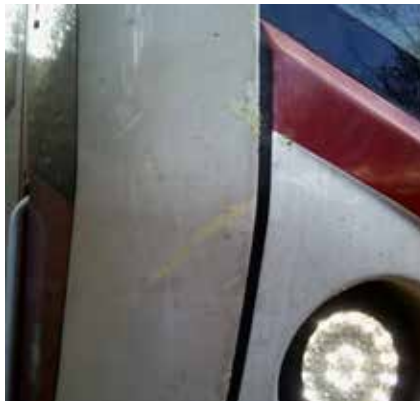
Poškodený lak karosérie vlaku Os 6112 (ZSSK) v dôsledku spadnutého stromu v úseku Banská Štiavnica – Hronská Dúbrava.
