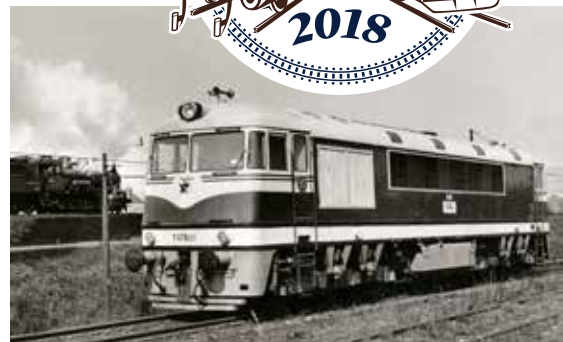
Dieselelektrické rušne z ČKD radu T 678.0 začali nahrádzať parné rušne na neelektrifikovaných hlavných tratiach.
