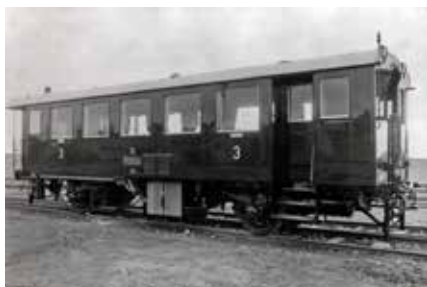
Motorový vozeň radu M 122.0 s elektrickým prenosom Gebus z roku 1930.
