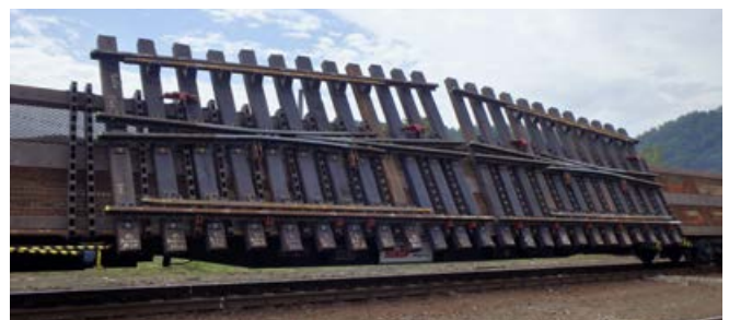
Časť nových výhybiek bola prepravovaná priamo na stavenisko na špeciálnych vagónoch.
