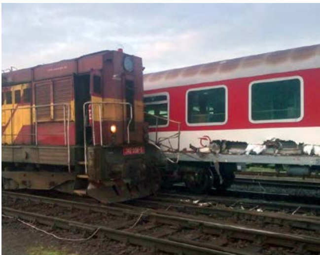
Rýchlik a posunujúci rušeň sa zrazili bočne na výhybke v Plešivci.
