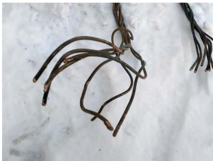
Detailné fotografie z miesta mimoriadnosti ilustrujú poškodené prídavné lano trakčného vedenia.
